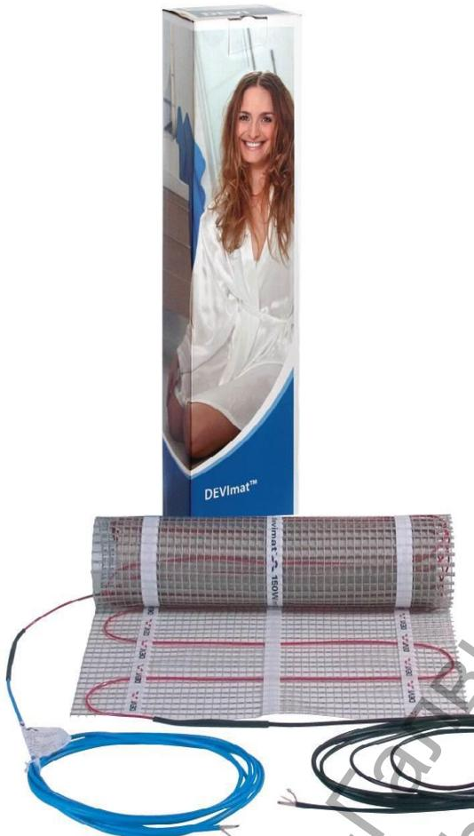
Нагревателен кабел с два захранващи края, разположен върху самозалепваща се мрежа под формата на рогозка с мощност 150 W/m<sup>2</sup>. Рогозката е с дебелина 2.5 mm и може да се инсталира в замазката непосредствено под подовото покритие без да се налага повдигане нивото на пода. Произвеждат се на стандартни дължини. Муфите са фабрични, херметични в комплект със студени захранващи краища.
